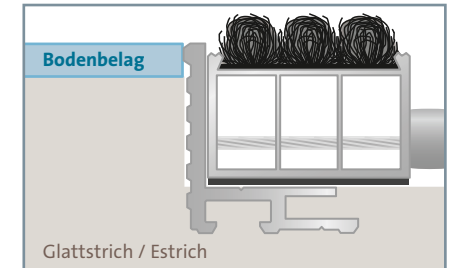
Montage: Der Winkelrahmen muss bündig mit Bodenbelag und Glattstrich / Estrich abschließen
