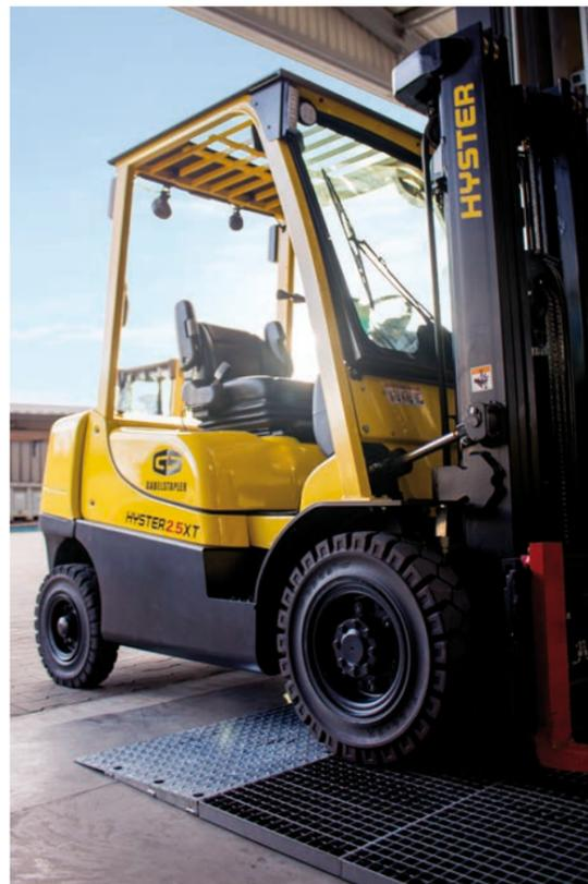
Bei aufliegender Verlegung über eine Rampe befahrbar.
