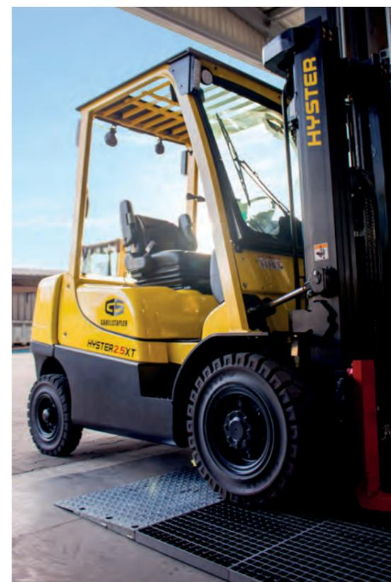
Bei aufliegender Verlegung über eine Rampe befahrbar.
