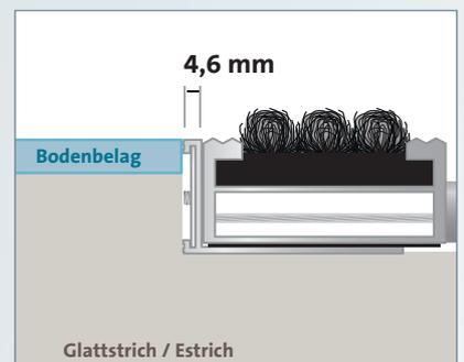
Montage: Der Winkelrahmen muss bündig mit Bodenbelag und Glattstrich / Estrich abschließen.
