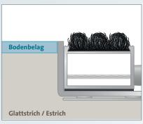
Montage: Der Winkelrahmen muss bündig mit Bodenbelag und Glattstrich / Estrich abschließen.
