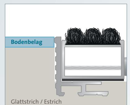
Montage: Der Winkelrahmen muss bündig mit Bodenbelag und Glattstrich / Estrich abschließen.
